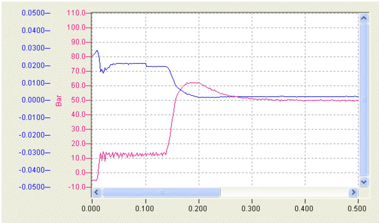
Beispiel für das Verhalten des Reglers, wenn die Achse zunächst einen Weg zurücklegen muss, bevor sie den geforderten Druck aufzubauen vermag.
