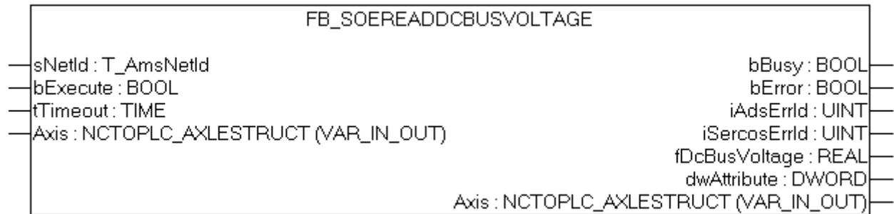
Mit dem Funktionsbaustein FB\_SoEReadDcBusVoltage kann die DC-Bus-Spannung des Antriebs (S-0-0380) eingelesen werden.
