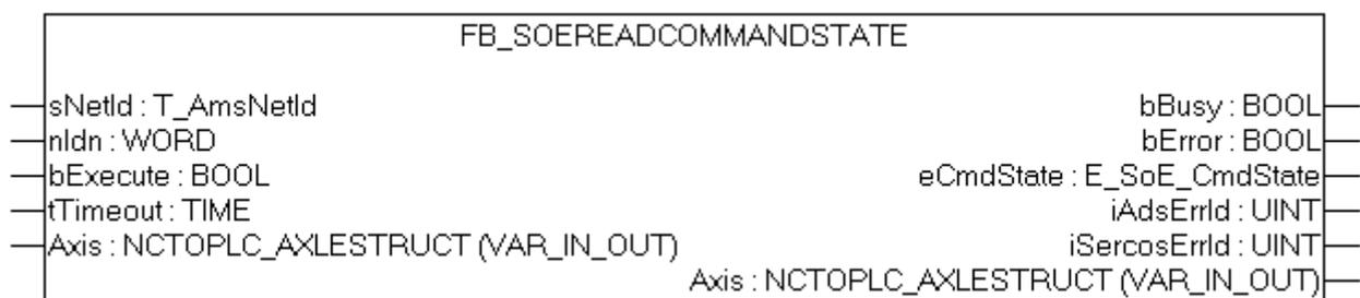
Mit dem Funktionsbaustein FB\_SoEReadCommandState kann die Kommandoausführung überprüft werden.
