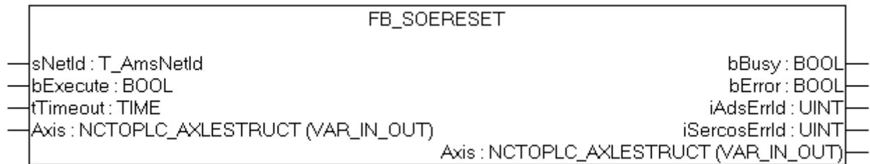
Mit dem Funktionsbaustein FB\_SoEReset kann ein Antriebsreset (S-0-0099) ausgeführt werden. Bei mehrkanaligen Geräten müssen ggf. beide Kanäle einen Reset ausführen. Die Timeoutzeit muss 10s betragen, da der Reset je nach Fehler bis zu 10s dauern kann.
