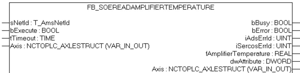
Mit dem Funktionsbaustein FB\_SoEReadAmplifierTemperature kann die Temperatur des Antriebs (S-0-0384) eingelesen werden.
