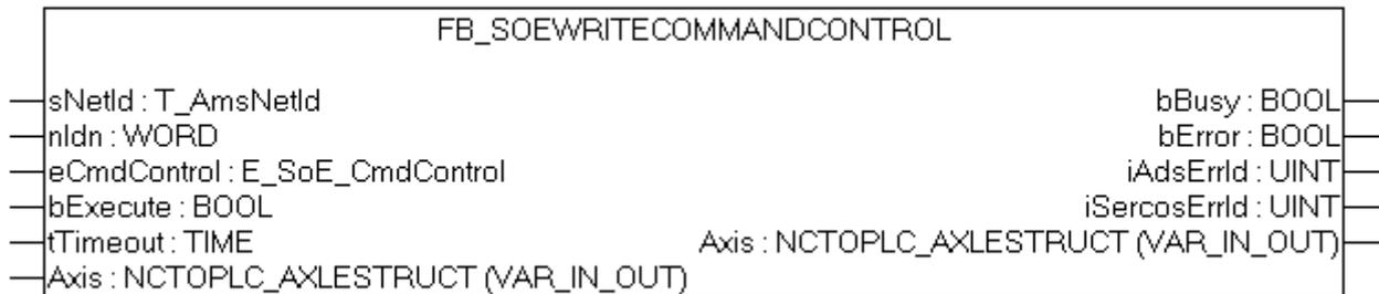
Mit dem Funktionsbaustein FB\_SoEWriteCommandControl kann ein Kommando vorbereitet, gestartet oder abgebrochen werden.
