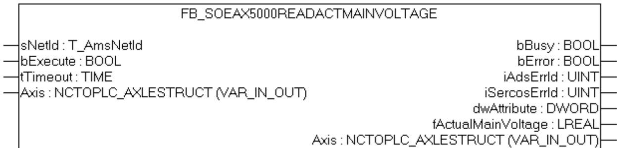
Mit dem Funktionsbaustein FB\_SoEAX5000ReadActMainVoltage kann der aktuelle Scheitelwert der Netzspannung des AX5000 (P-0-0200) eingelesen werden.
