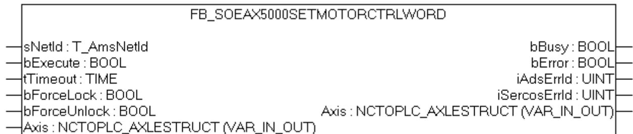
Mit dem Funktionsbaustein FB\_SoEAX5000SetMotorCtrlWord kann das ForceLock-Bit (Bit 0) bzw. das ForceUnlock-Bit im Motor Control Word (P-0-0096) gesetzt werden, um die Bremse zu setzen oder zu lösen. Im Normalfall wird die Bremse automatisch über das Enable des Antriebs gehandhabt.
