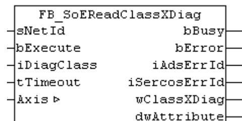
Mit dem Funktionsbaustein FB\_SoEReadClassXDiag kann die aktuelle Class 1 Diagnose(S-0-0011) ... Class 3 Diagnose (S-0-0013) als WORD ausgelesen werden. Für die Auswertung der Class 1 Diagnose als Struktur ST\_AX5000\_C1D gibt es eine Konvertierungsfunktion F\_ConvWordToSTAX5000C1D. Siehe Dokumentation TcDrive.lib.
