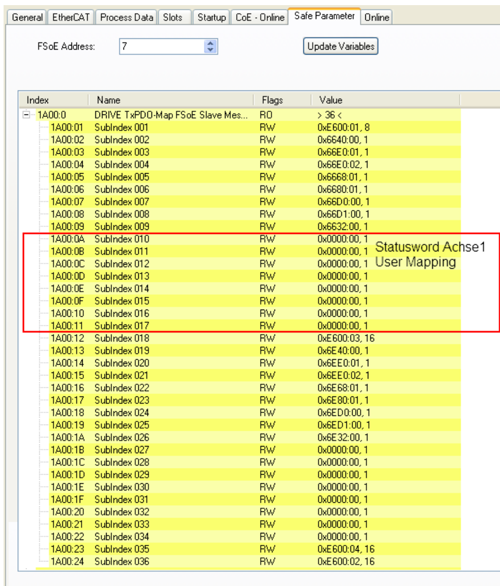
Abb. 18: Status-Wort User Mapping für Achse1 (2. Byte variable Belegung)
