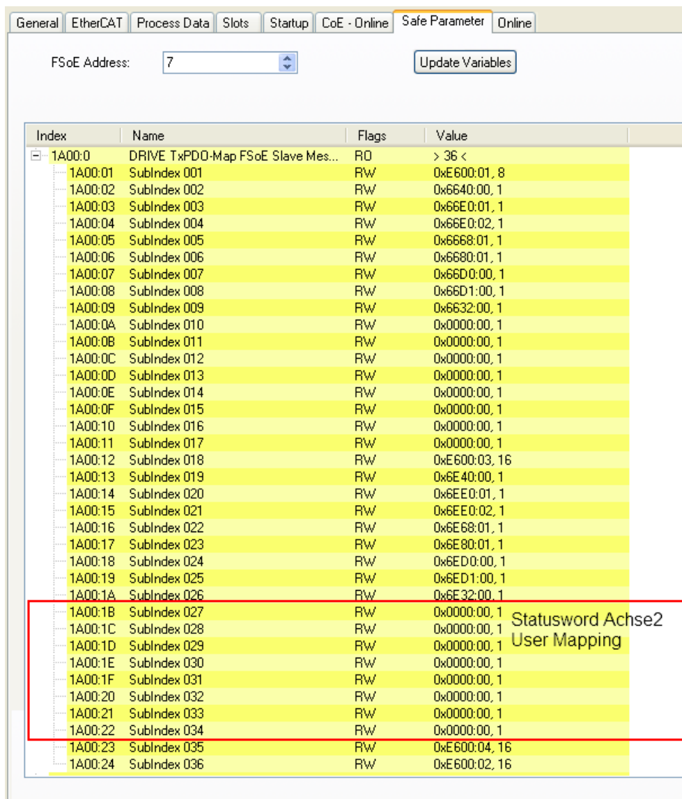
Abb. 20: Status-Word User Mapping für Achse2 (2. Byte variable Belegung)
