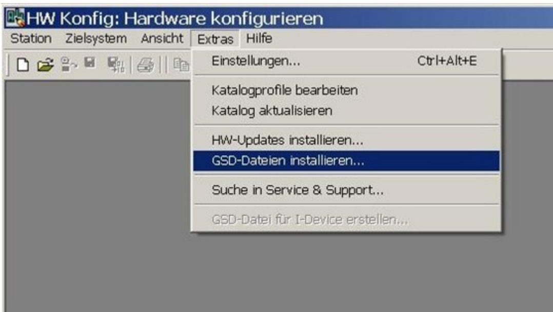
Abb. 48: Installieren der EL6930 in Step7
