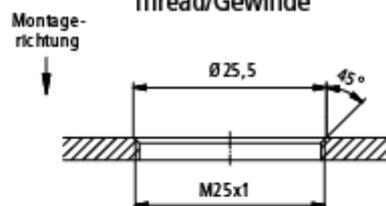
min. wall thickness 1 mm/
