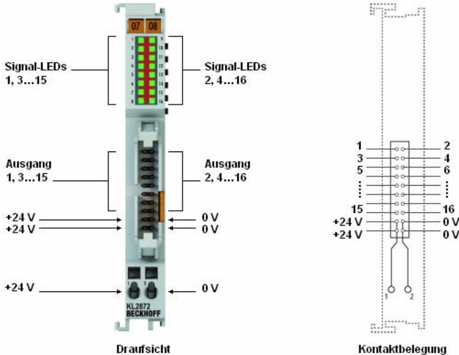
**Sechzehnkanalige Digitalausgangsklemme mit Flachkabelanschluss, 24 V<sub>DC</sub>**
