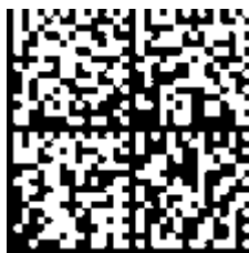
Abb. 17: Beispiel-DMC 1P 072222 SBTN k4p562d7 1KEL 1809 Q1 51S 678294
