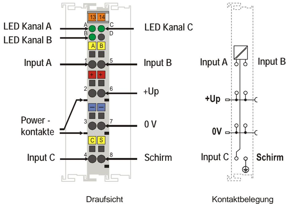
**Interface-Klemmen für Inkremental-Encoder mit Sonderbetriebsart *Frequenzmessung über einstellbares Zeitfenster***
