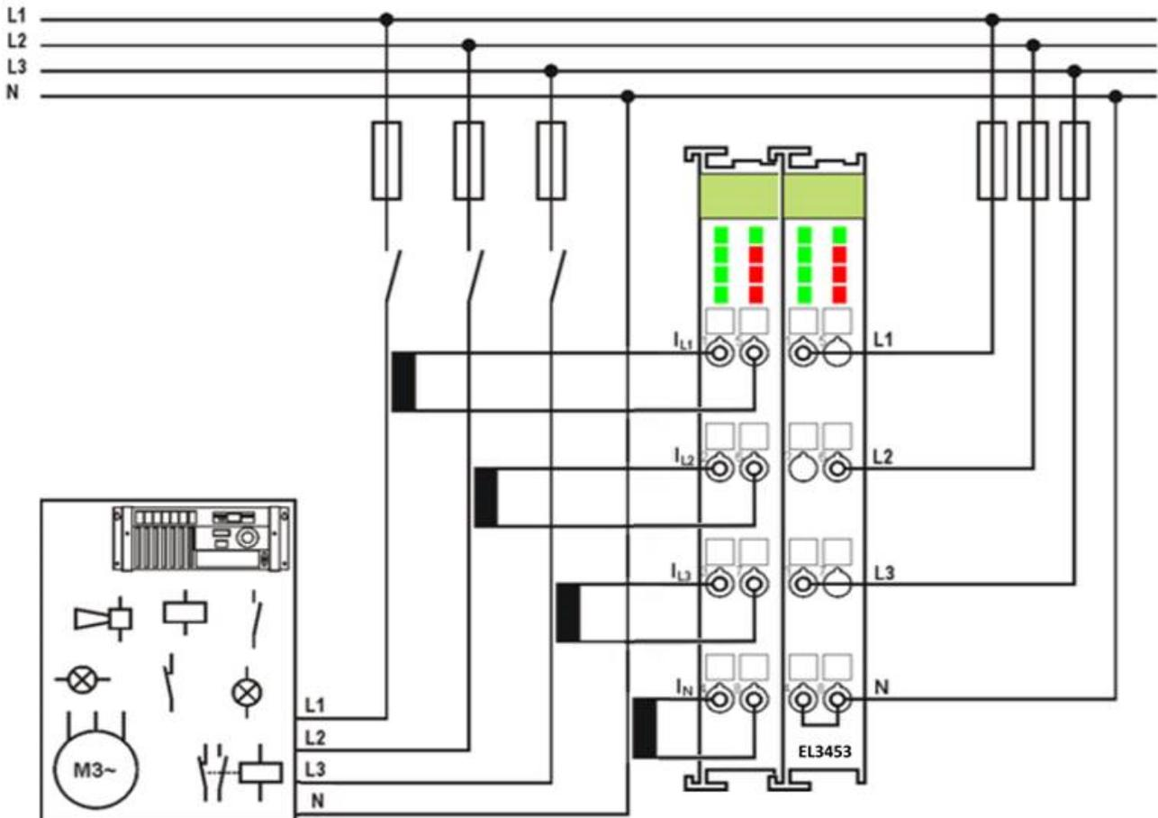
Abb. 39: Leistungsmessung an einer Maschine mit der EL3453
