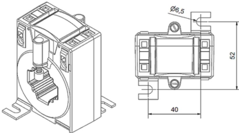
Abb. 15: Isometrische Ansicht, Draufsicht; alle Angaben in mm
