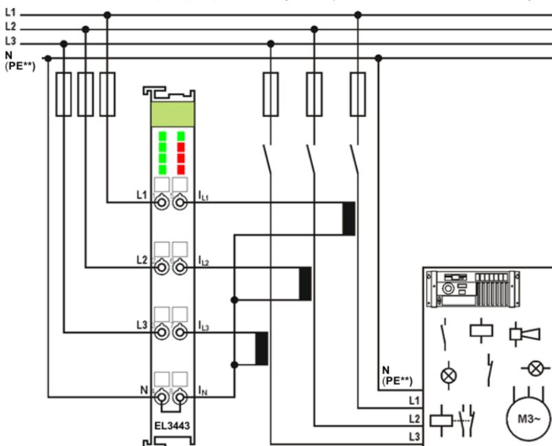
Abb. 38: Leistungsmessung an einer Maschine mit der EL3443
