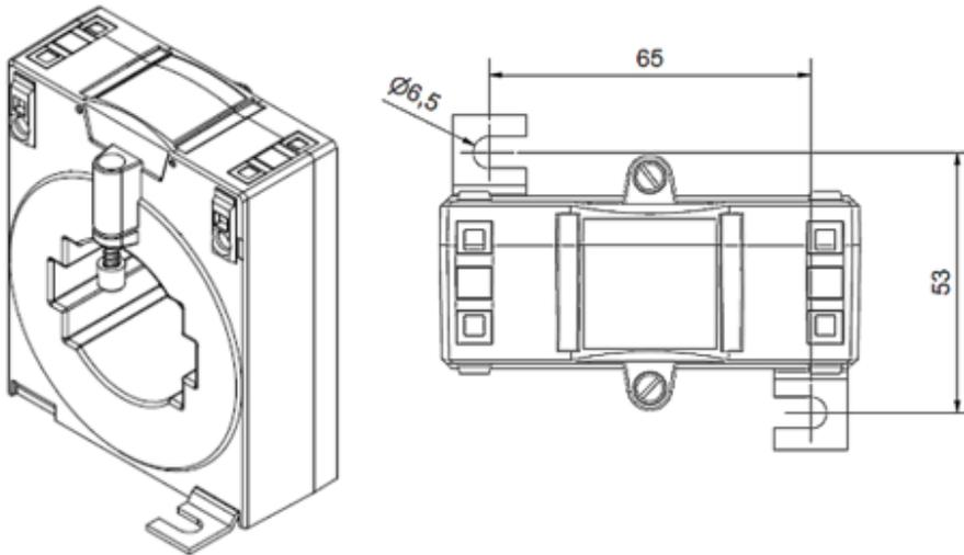
Abb. 19: Isometrische Ansicht, Draufsicht; alle Angaben in mm
