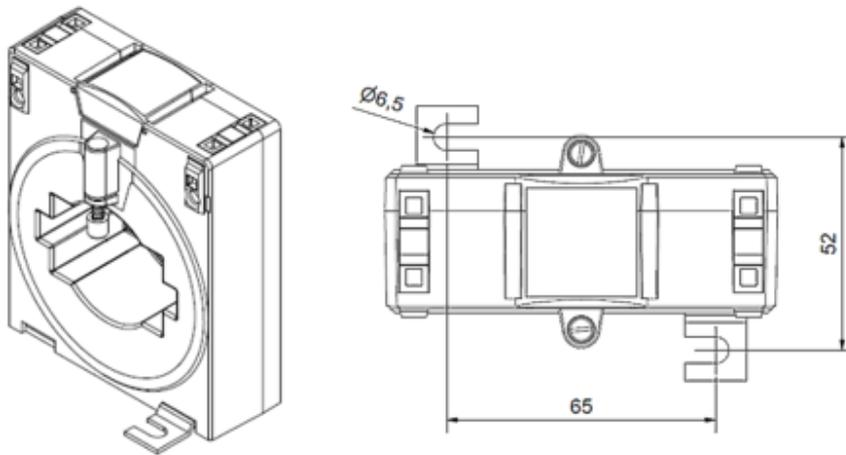
Abb. 21: Isometrische Ansicht, Draufsicht; alle Angaben in mm
