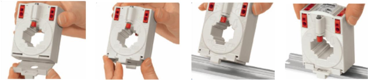
Abb. 32: Montage auf 35 mm DIN-Hutschiene mit Schnappbefestigung (ZB8201-0210)
