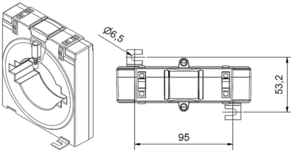
Abb. 25: Isometrische Ansicht, Draufsicht; alle Angaben in mm
