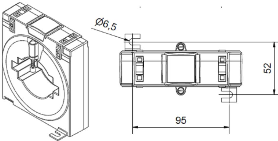
Abb. 23: Isometrische Ansicht, Draufsicht; alle Angaben in mm
