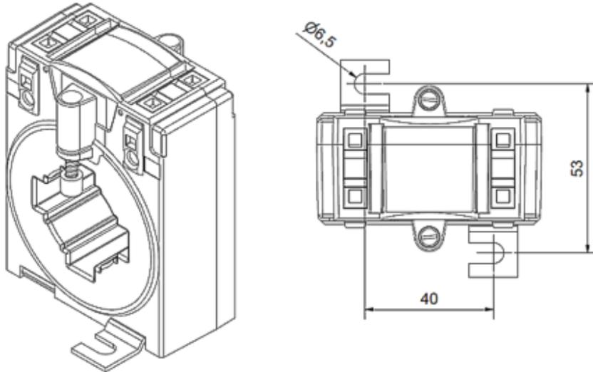
Abb. 17: Isometrische Ansicht, Draufsicht; alle Angaben in mm
