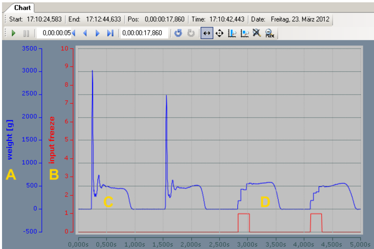
Abb. 18: Stöße auf Wägezelle mit und ohne InputFreeze
