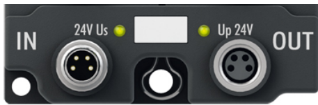
Abb. 13: Steckverbinder für Versorgungsspannungen
