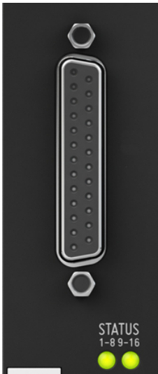
Fig. 36: D-sub 25 status LEDs
