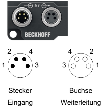
Abb. 6: M8-Steckverbinder
