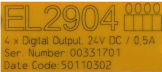
Abb. 31: EL2904 IP20 Safety Klemme mit Chargennummer/ DateCode 50110302 und eindeutiger Seriennummer 00331701
