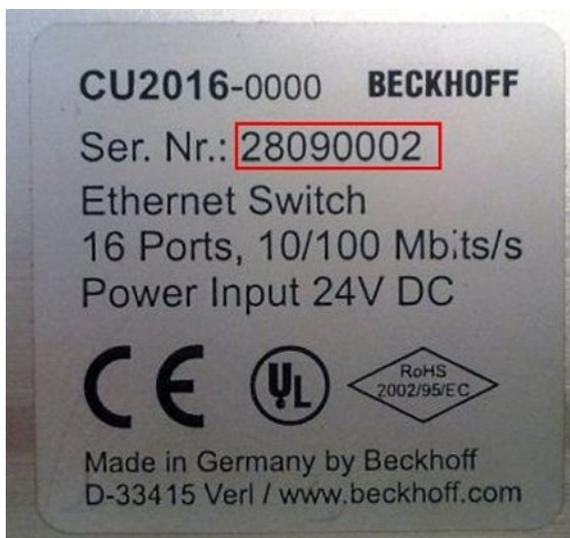
Abb. 27: CU2016 Switch mit Seriennummer/ Chargennummer
