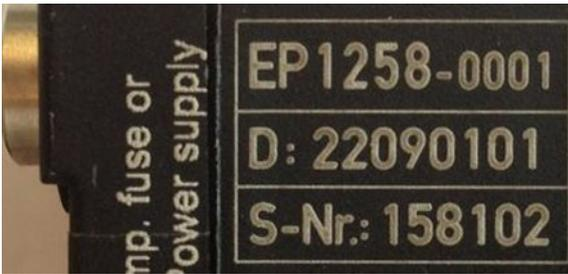
Abb. 29: EP1258-0001 IP67 EtherCAT Box mit Chargennummer/ DateCode 22090101 und eindeutiger Seriennummer 158102
