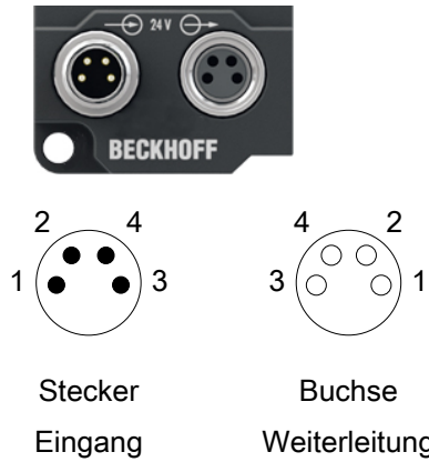
Abb. 3: M8-Steckverbinder
