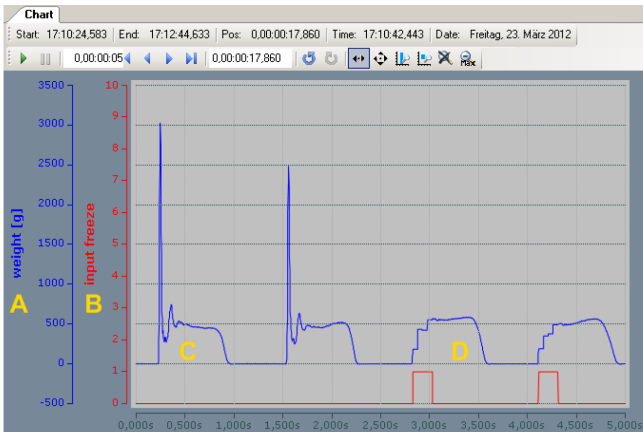
Abb. 13: Stöße auf Wägezelle mit und ohne InputFreeze
