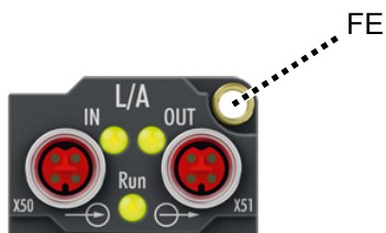
Abb. 1: Anschluss für die Funktionserdung (FE)
