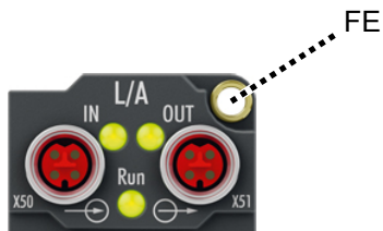
Abb. 1: Anschluss für die Funktionserdung (FE)
