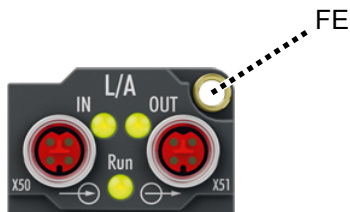
Abb. 2: Anschluss für die Funktionserdung (FE)
