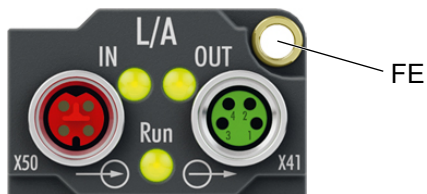
Abb. 1: Anschluss für die Funktionserdung (FE)
