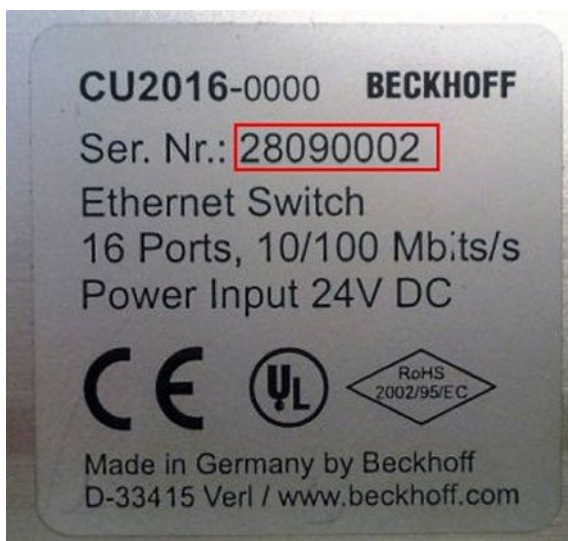
Abb. 6: CU2016 Switch mit Seriennummer/ Chargennummer
