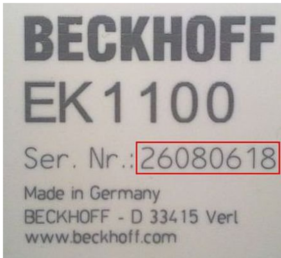
Abb. 5: EK1100 EtherCAT Koppler, Standard IP20-IO-Gerät mit Seriennummer/ Chargennummer
