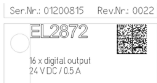
Abb. 3: EL2872 mit Revision 0022 und Seriennummer 01200815
