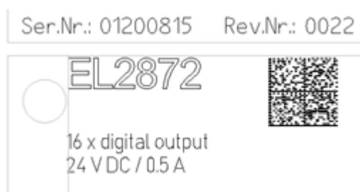
Abb. 1: EL2872 mit Revision 0022 und Seriennummer 01200815
