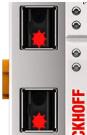
Abbildung: Transmitterkanäle beim EK1541
