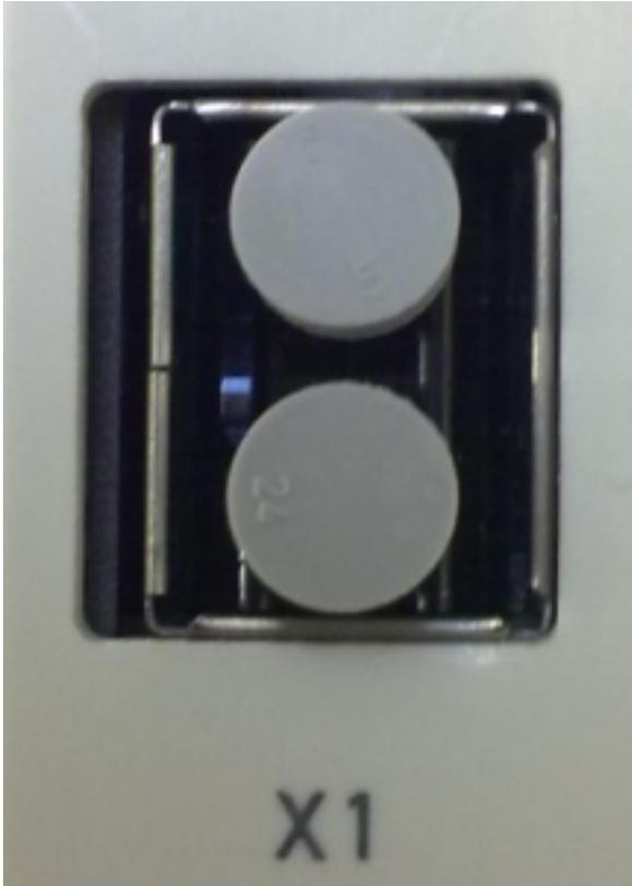
Abbildung: Blindstopfen in nicht verwendeten Anschlussbuchsen
