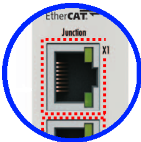
Abb. 11: Kennzeichnung FHC-Port am EK1122-0080 bzw. EK1101-0080
