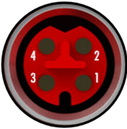
Abb. 30: Pinbelegung M8, EtherCAT P In und EtherCAT P Out
