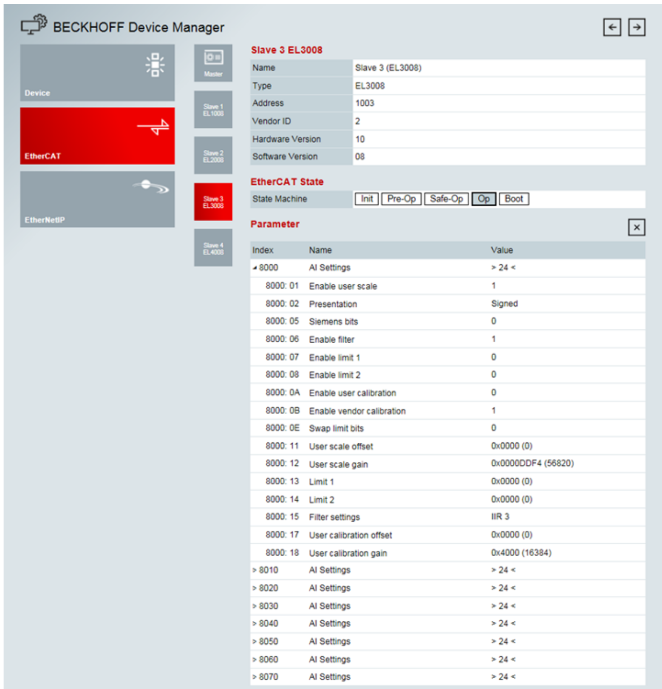
Abb. 20: Konfiguration über HTML-Seiten - Parametrierung der EtherCAT-Klemmen
