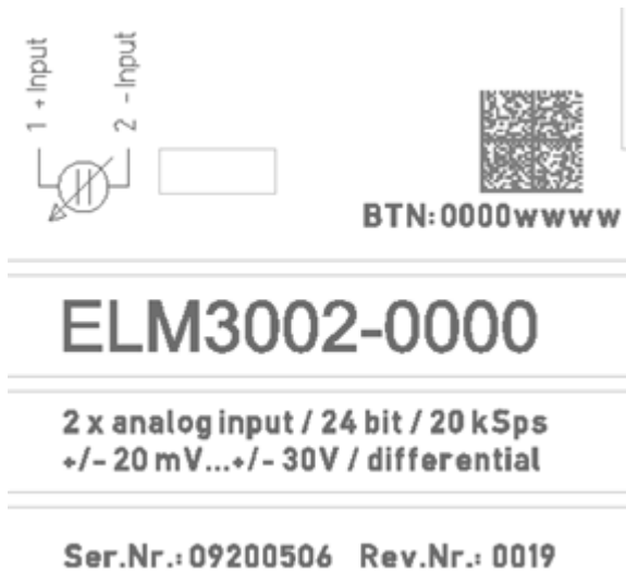
Abb. 3: ELM3002-0000 mit eindeutiger BTN 0000www und Seriennummer 09200506
