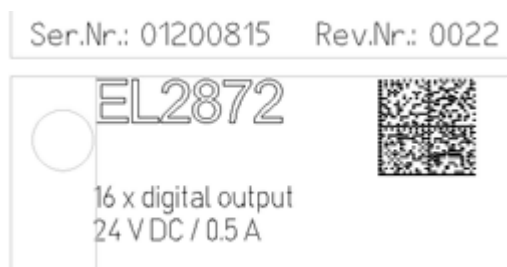
Abb. 2: EL2872 mit Revision 0022 und Seriennummer 01200815
