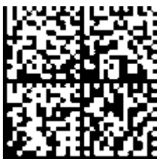
Fig. 5: Example DMC 1P 072222 SBTN k4p562d7 1K EL1809 Q 1 51S 678294
