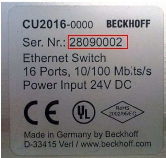
Abb. 3: CU2016 Switch mit Seriennummer/ Chargennummer
