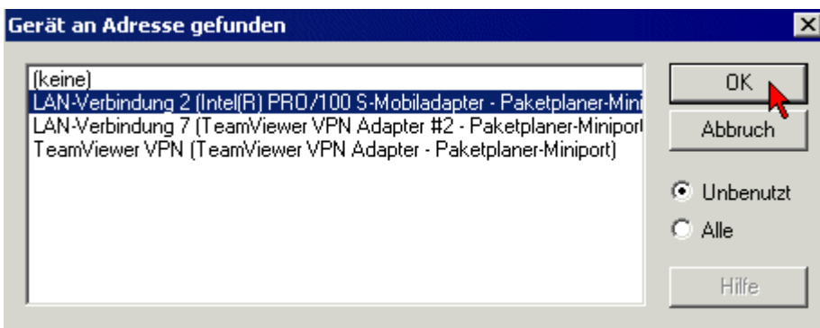
Abb. 163: Auswahl und Bestätigung des Ethernet-Adapters
