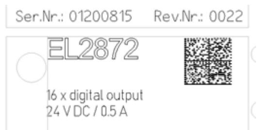
Abb. 1: EL2872 mit Revision 0022 und Seriennummer 01200815
