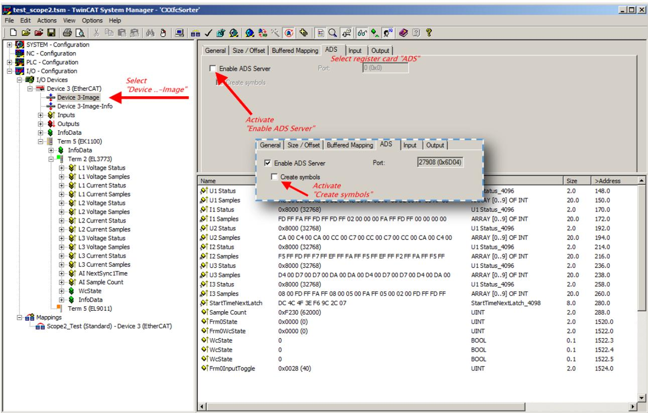
Abb. 155: Aktivierung des ADS Servers des EtherCAT Device (TwinCAT 2)
