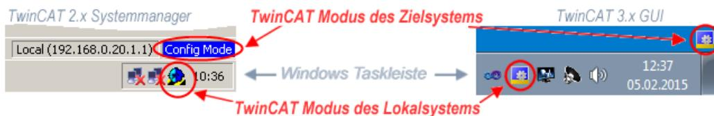
Abb. 89: Unterscheidung Lokalsystem/ Zielsystem (links: TwinCAT 2; rechts: TwinCAT 3)
