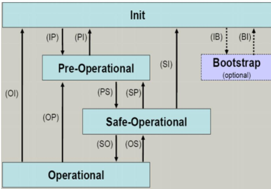
Abb. 7: Zustände der EtherCAT State Machine
