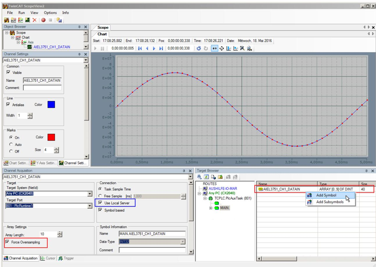
Abb. 154: Darstellung einer 10 x Oversampling-Variablen der EL3751 mit dem Scope2
