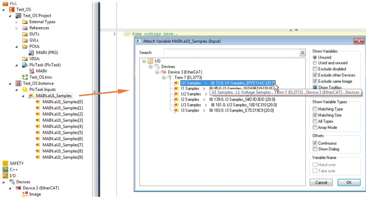
Abb. 136: Auswahl des EL3773 PDO "L1 Voltage Samples" zum Erstellen eines Links mit der PLC Feldvariablen „aU1\_Samples“
