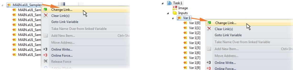
Abb. 135: Setzen der Verknüpfung der PLC Feldvariablen (links: vorhergehender Schritt 2a; rechts: : vorhergehender Schritt 2b)
