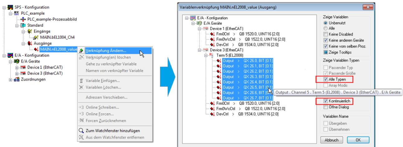
Abb. 36: Auswahl von mehreren PDO gleichzeitig: Aktivierung von „Kontinuierlich“ und „Alle Typen“
