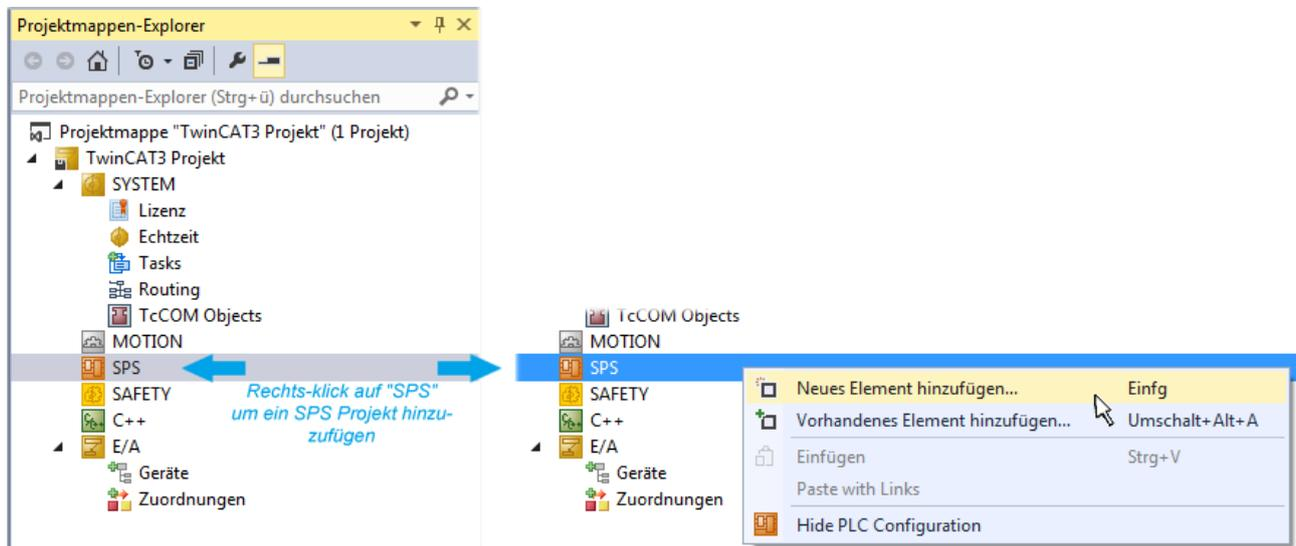
Abb. 49: Einfügen der Programmierumgebung in „SPS“
