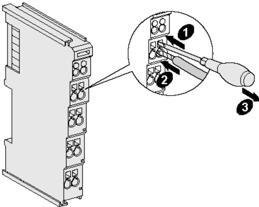
Abb. 15: Befestigung einer Leitung an einem Klemmenanschluss
