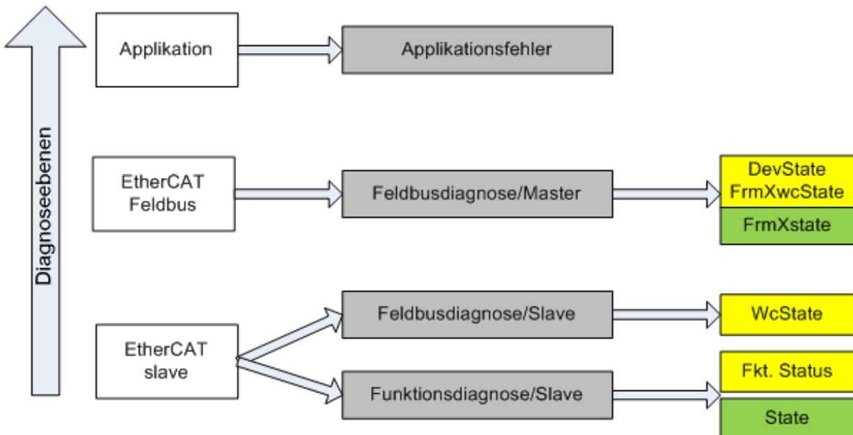
Abb. 120: Auswahl an Diagnoseinformationen eines EtherCAT Slave
