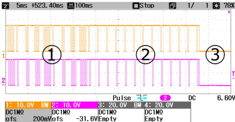
Abb. 161: default Ausgabeverhalten bei deaktivierter CycleCounter-Überwachung
