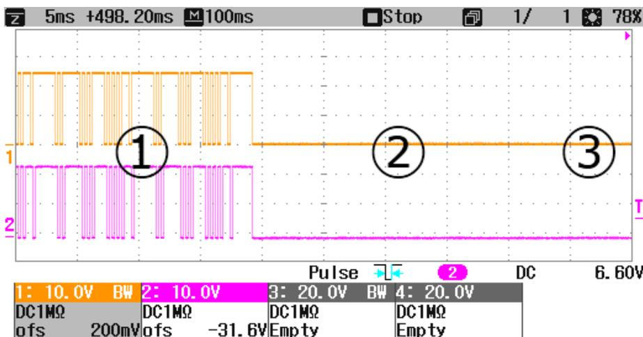
Abb. 162: default Ausgabeverhalten bei aktivierter CycleCounter-Überwachung
