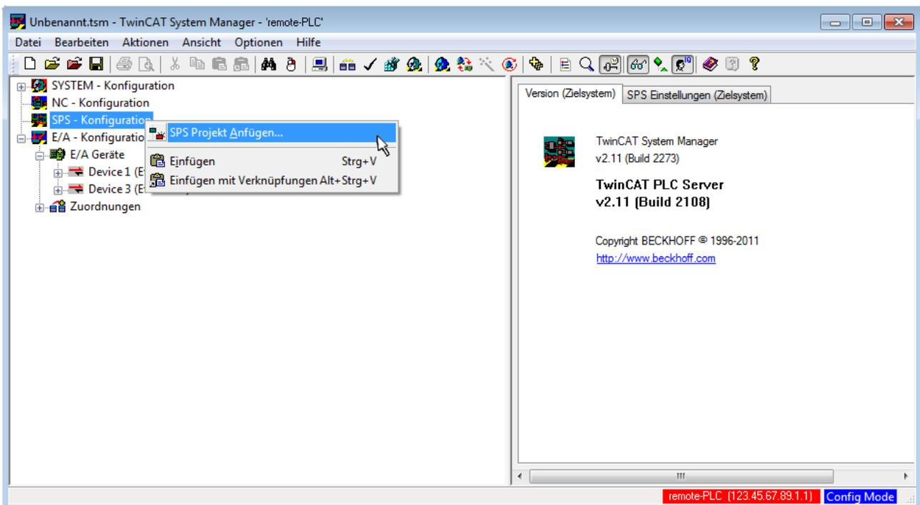
Abb. 32: Hinzufügen des Projektes des TwinCAT PLC Control
