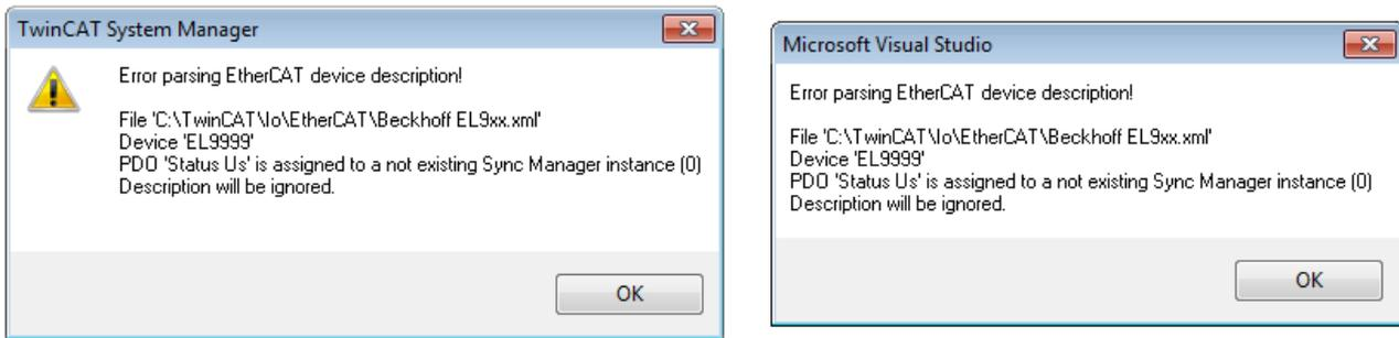
Abb. 76: Hinweisfenster fehlerhafte ESI-Datei (links: TwinCAT 2; rechts: TwinCAT 3)
