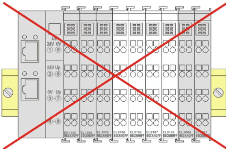
Abb. 19: Inkorrekte Positionierung
