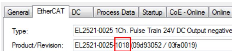
Abb. 94: Einbau EtherCAT-Klemme mit Revision -1018
