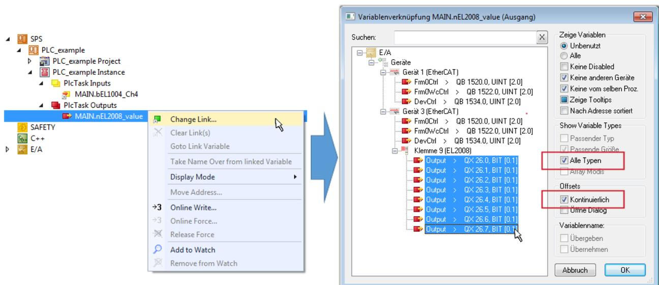
Abb. 56: Auswahl von mehreren PDO gleichzeitig: Aktivierung von „Kontinuierlich“ und „Alle Typen“
