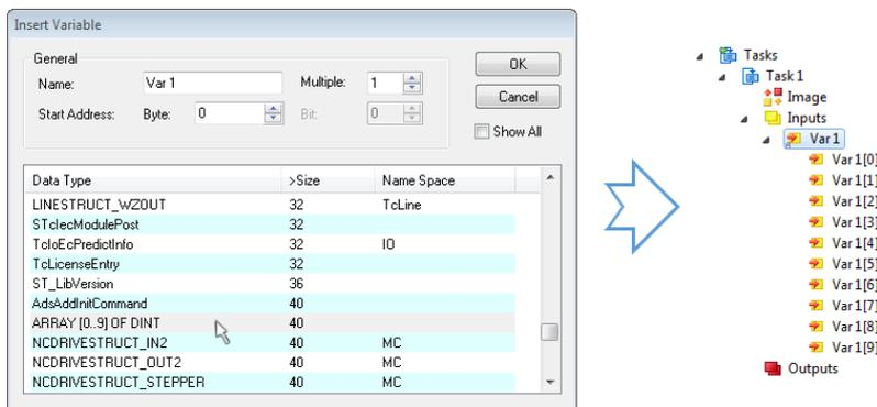
Abb. 134: Einfügen der zum Oversampling passenden Variablen „Var 1“
