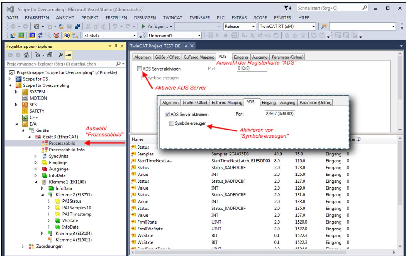
Abb. 140: Aktivierung des ADS Servers des EtherCAT Device (TwinCAT 3)
