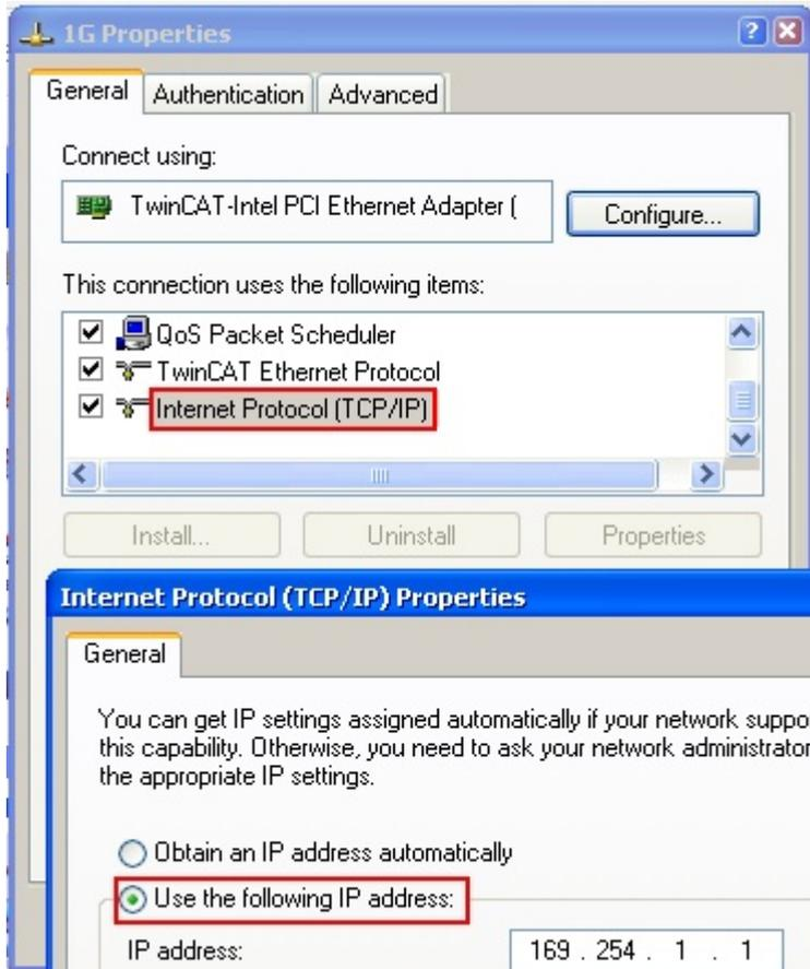
Abb. 70: TCP/IP-Einstellung des Ethernet Ports
