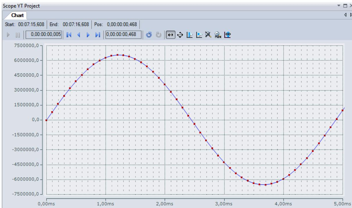
Abb. 139: Beispiel einer Messung eines Sinussignals mit 10 Fach Oversampling bei 1 ms Messzykluszeit
