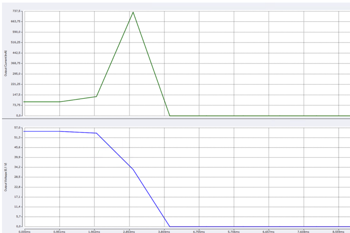
Abb. 235: Zeit für die Detektion eines Kurzschlusses
