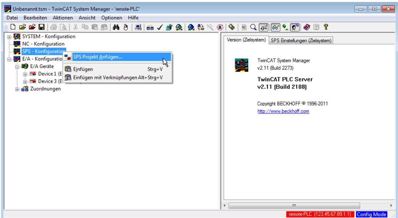
Abb. 44: Hinzufügen des Projektes des TwinCAT PLC Control
