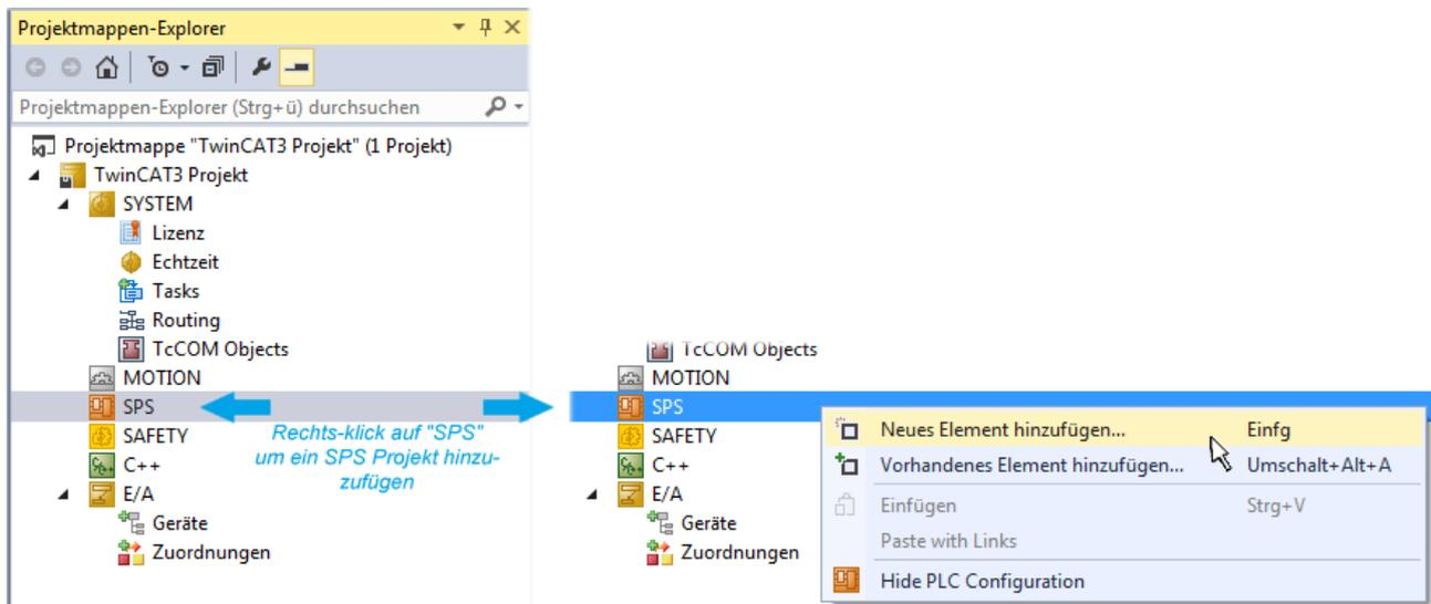
Abb. 61: Einfügen der Programmierumgebung in „SPS“
