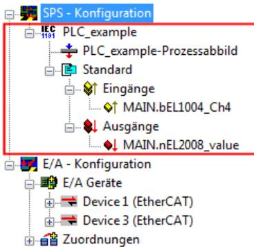
Abb. 45: Eingebundenes PLC Projekt in der SPS- Konfiguration des System Managers
