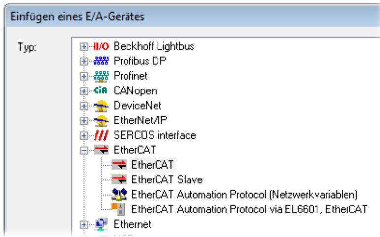
Abb. 92: Auswahl EtherCAT Anschluss (TwinCAT 2.11, TwinCAT 3)
