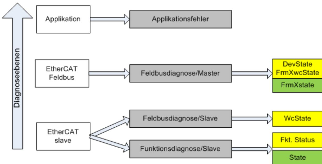
Abb. 132: Auswahl an Diagnoseinformationen eines EtherCAT Slave
