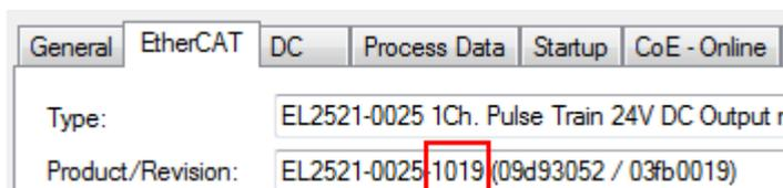
Abb. 107: Erkennen EtherCAT-Klemme mit Revision -1019
