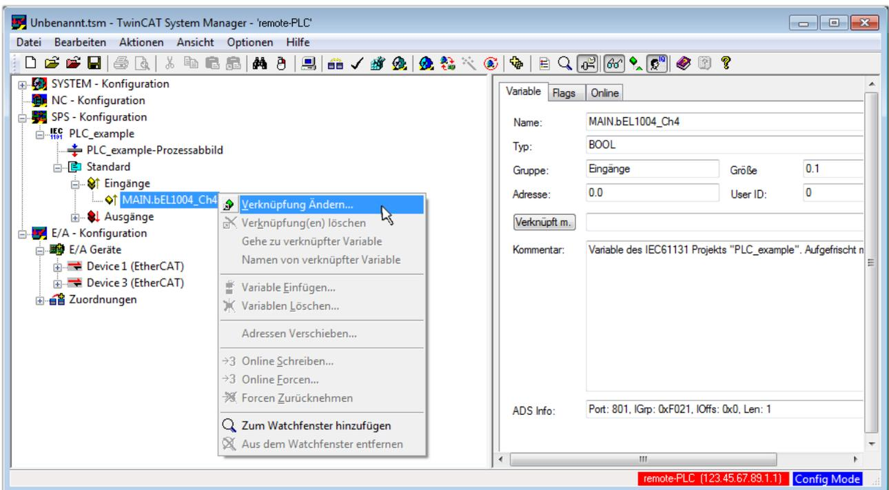
Abb. 46: Erstellen der Verknüpfungen PLC-Variablen zu Prozessobjekten
