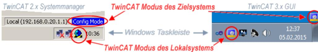
Abb. 101: Unterscheidung Lokalsystem/ Zielsystem (links: TwinCAT 2; rechts: TwinCAT 3)
