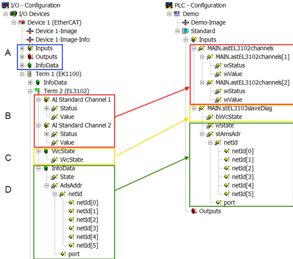
Abb. 133: Grundlegende EtherCAT Slave Diagnose in der PLC
