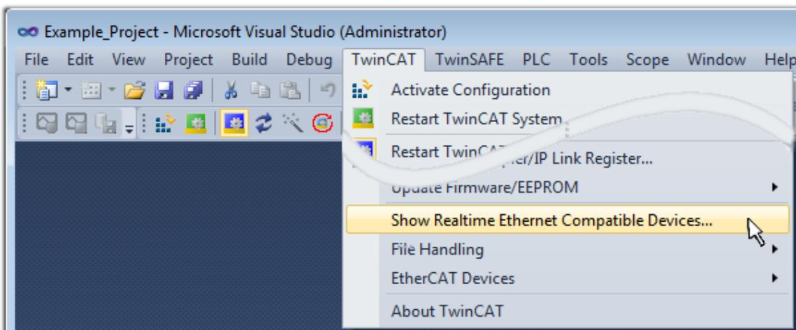
Abb. 76: Aufruf in VS Shell (TwinCAT 3)
