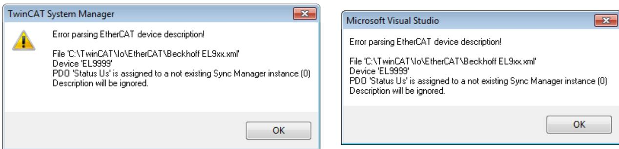
Abb. 88: Hinweisfenster fehlerhafte ESI-Datei (links: TwinCAT 2; rechts: TwinCAT 3)
