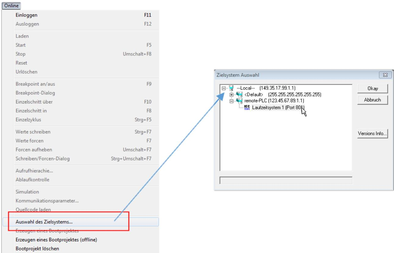
Abb. 50: Auswahl des Zielsystems (remote)
