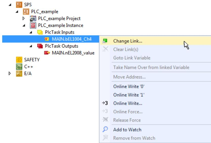
Abb. 66: Erstellen der Verknüpfungen PLC-Variablen zu Prozessobjekten
