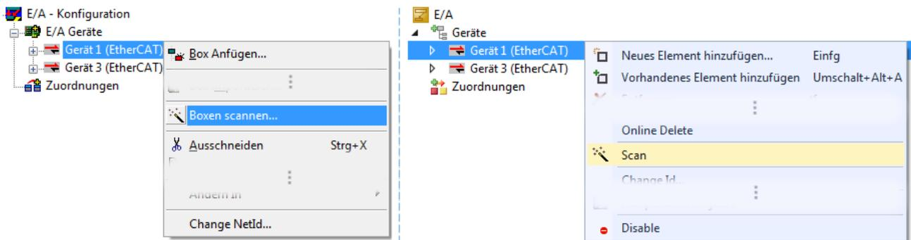
Abb. 109: Manuelles Auslösen des Teilnehmer-Scans auf festgelegtem EtherCAT Device (links: TwinCAT 2; rechts TwinCAT 3)
