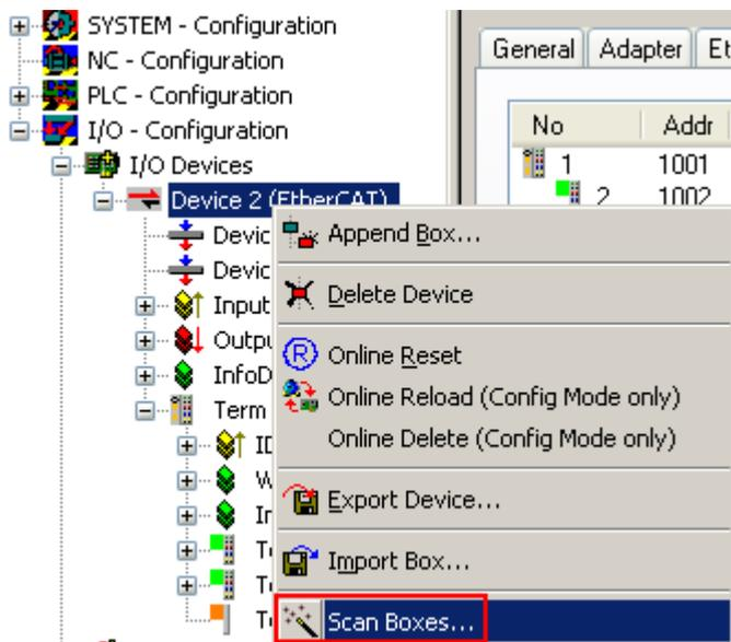
Abb. 143: Rechtsklick auf das EtherCAT Gerät bewirkt das Scannen des unterlagerten Feldes
