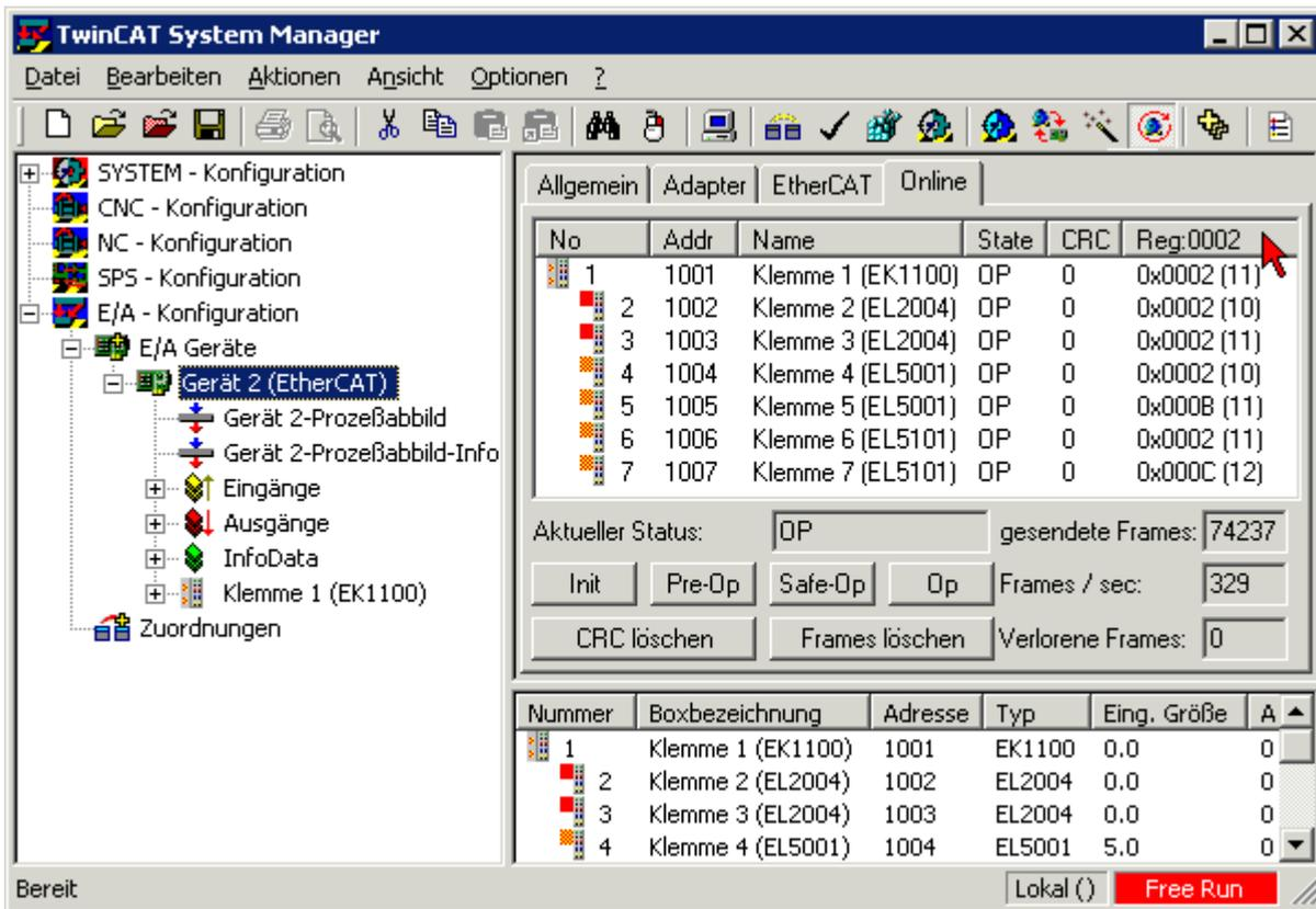
Abb. 150: Versionsbestimmung FPGA-Firmware
