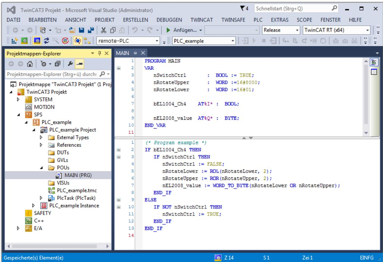
Abb. 64: Beispielprogramm mit Variablen nach einem Kompilervorgang (ohne Variablenanbindung)
