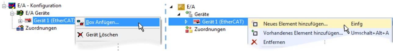
Abb. 95: Anfügen von EtherCAT Geräten (links: TwinCAT 2; rechts: TwinCAT 3)
