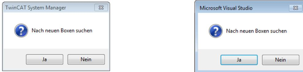
Abb. 108: Scan-Abfrage nach dem automatischen Anlegen eines EtherCAT Gerätes (links: TwinCAT 2; rechts TwinCAT 3)
