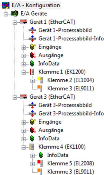
Abb. 40: Abbildung der Konfiguration im TwinCAT 2 System Manager
