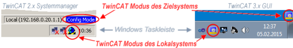
Abb. 142: Unterscheidung Lokalsystem/ Zielsystem (links: TwinCAT 2; rechts: TwinCAT 3)
