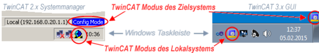
Abb. 57: Unterscheidung Lokalsystem/ Zielsystem (links: TwinCAT 2; rechts: TwinCAT 3)
