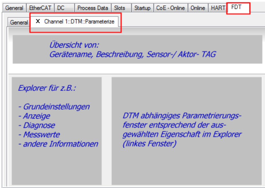
Abb. 130: Allgemeiner Aufbau eines DTM-Konfigurationsfensters innerhalb des Field Device Tools (FDT)
