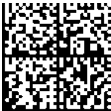
Abb. 3: Beispiel-DMC 1P 072222 SBTN k4p562d7 1K EL1809 Q 1 51S 678294
