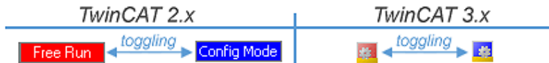
附图 143: 显示在状态栏下方的“Free Run”和“Config Mode”来回切换
