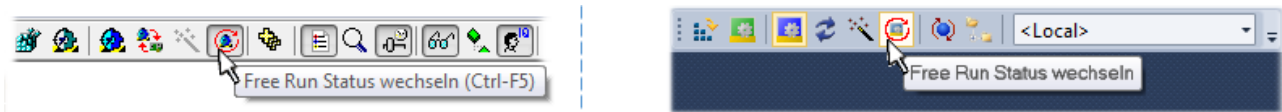
Abb. 76: TwinCAT kann auch durch einen Button in diesen Zustand versetzt werden (links: TwinCAT 2; rechts TwinCAT 3)
