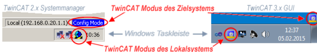
Abb. 101: Unterscheidung Lokalsystem/ Zielsystem (links: TwinCAT 2; rechts: TwinCAT 3)
