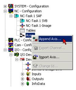
Fig. 169: Insert axis
