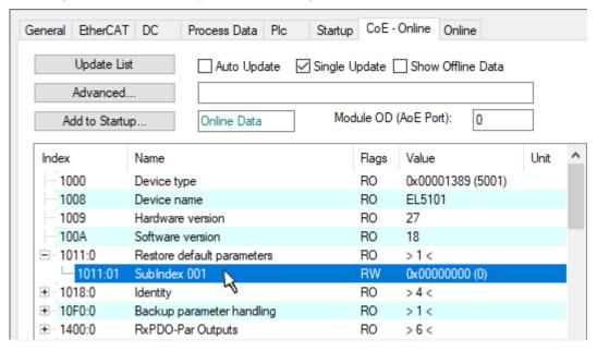
Fig. 189: Selecting the Restore default parameters PDO
