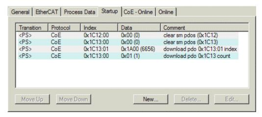
Fig. 127: "Startup" tab
