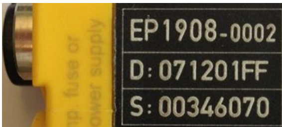
図 6: バッチ番号/日付コード071201FFおよび固有のシリアル番号00346070が記載されたEP1908-0002 IP67 EtherCAT安全ボックス
