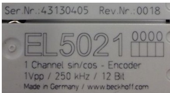
図 1: シリアル/バッチ番号、およびリビジョンIDが記載されたEL5021 ELターミナル、標準IP20 I0デバイス (2014年1月以降の印字)
