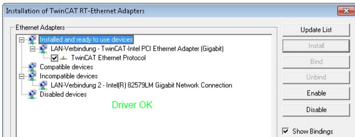
Abb. 21: Beispielhafte korrekte Treiber-Einstellung des Ethernet Ports
