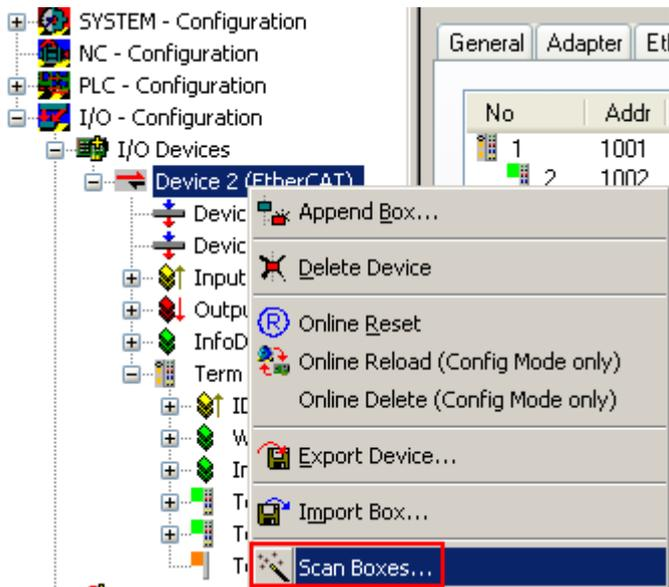
Abb. 86: Rechtsklick auf das EtherCAT Gerät bewirkt das Scannen des unterlagerten Feldes
