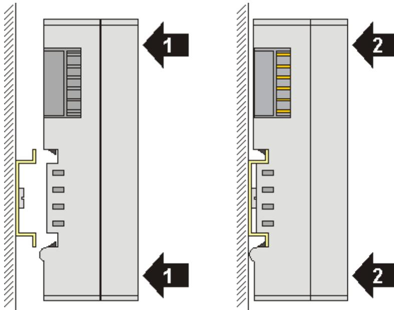
und drücken Sie (1) das Klemmenmodul gegen die Tragschiene, bis es auf der Tragschiene einrastet (2).
