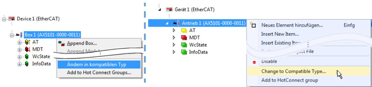
Abb. 61: Dialog „Change to Compatible Type...“ (links: TwinCAT 2; rechts TwinCAT 3)
