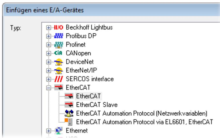
Abb. 33: Auswahl EtherCAT Anschluss (TwinCAT 2.11, TwinCAT 3)
