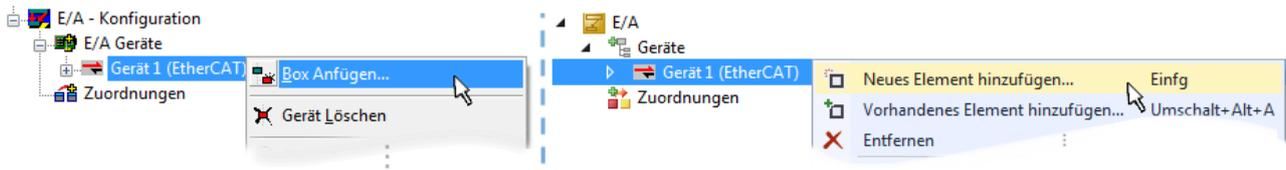
Abb. 36: Anfügen von EtherCAT-Geräten (links: TwinCAT 2; rechts: TwinCAT 3)
