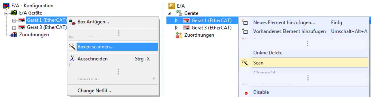
Abb. 50: Manuelles Auslösen des Teilnehmer-Scans auf festgelegtem EtherCAT Device (links: TwinCAT 2; rechts TwinCAT 3)
