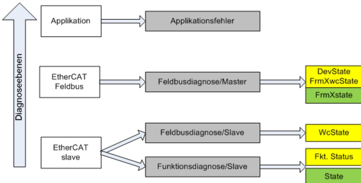
Abb. 73: Auswahl an Diagnoseinformationen eines EtherCAT Slave
