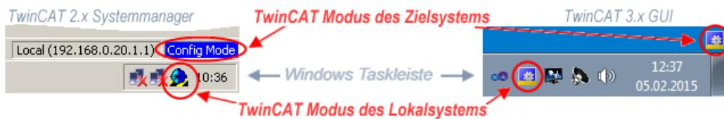
Abb. 42: Unterscheidung Lokalsystem/ Zielsystem (links: TwinCAT 2; rechts: TwinCAT 3)
