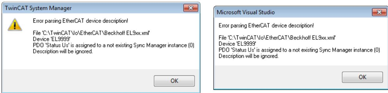
Abb. 29: Hinweisfenster fehlerhafte ESI-Datei (links: TwinCAT 2; rechts: TwinCAT 3)
