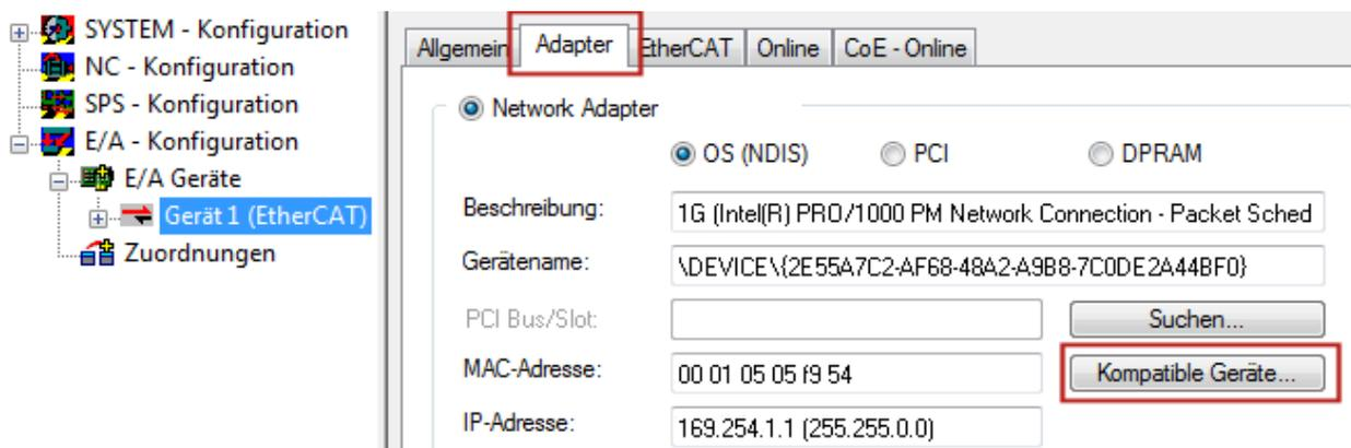
Abb. 19: Eigenschaft von EtherCAT-Gerät (TwinCAT 2): Klick auf „Kompatible Geräte...“ von „Adapter“
