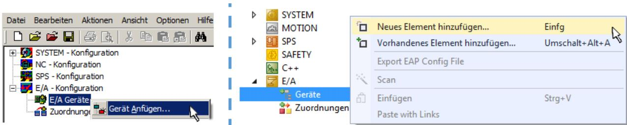
Abb. 32: Anfügen eines EtherCAT Device: links TwinCAT 2; rechts TwinCAT 3
