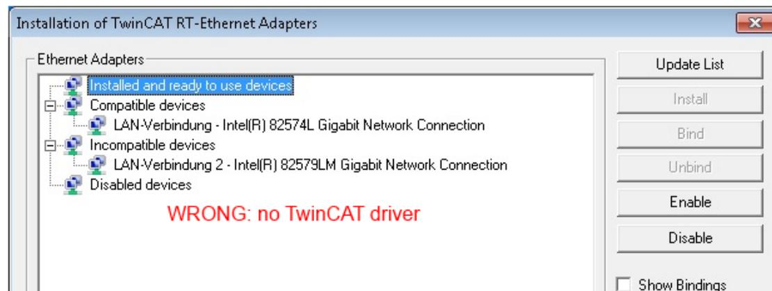
Abb. 22: Fehlerhafte Treiber-Einstellungen des Ethernet Ports
