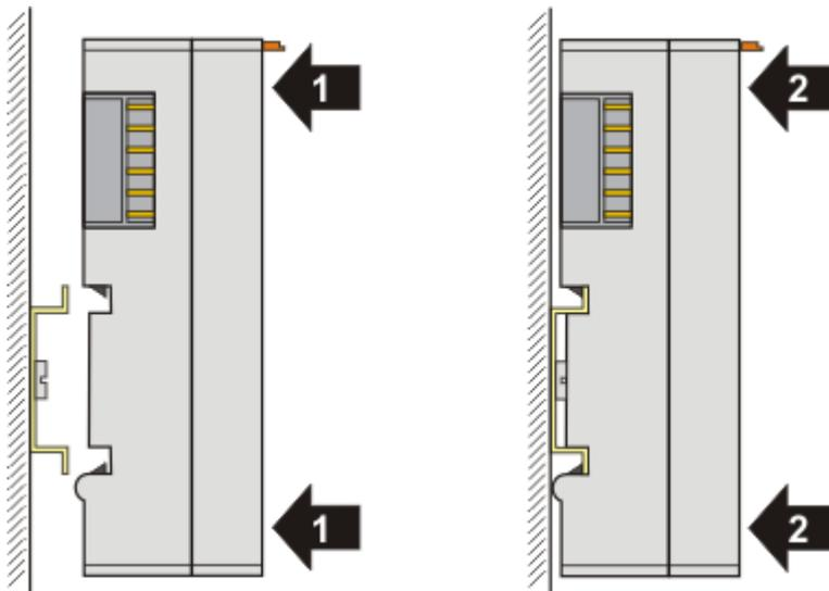
und drücken Sie (1) das Klemmenmodul gegen die Tragschiene, bis es auf der Tragschiene einrastet (2).
