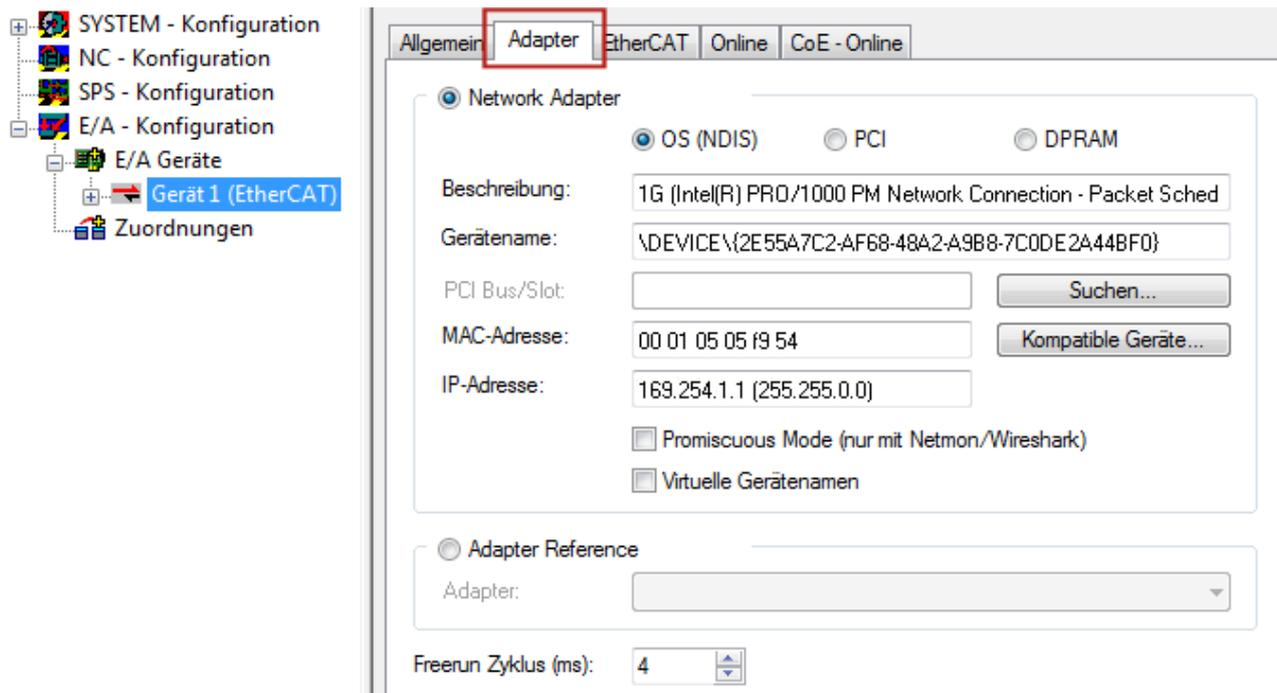
Abb. 35: Eigenschaften EtherCAT-Gerät (TwinCAT 2)
