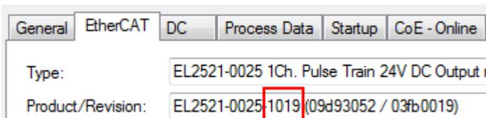
Abb. 48: Erkennen EtherCAT-Klemme mit Revision -1019
