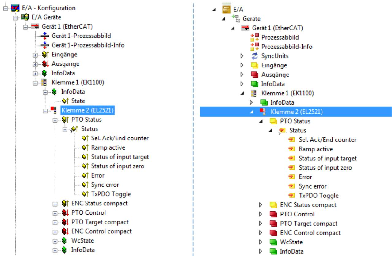
Abb. 41: EtherCAT Klemme im TwinCAT-Baum (links: TwinCAT 2; rechts: TwinCAT 3)
