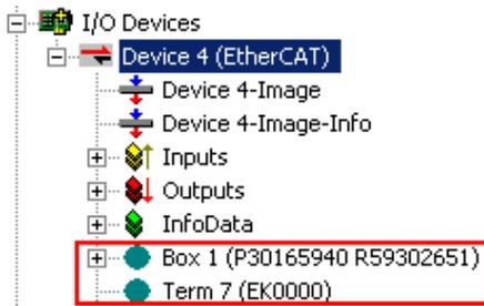
Abb. 56: Fehlerhafte Erkennung
