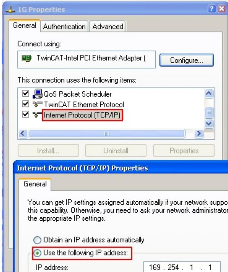
Abb. 23: TCP/IP-Einstellung des Ethernet Ports
