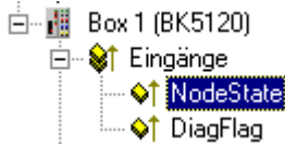
Abb. 142: TwinCAT Baum: Diagnose-Eingänge
