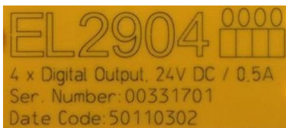
図 7: バッチ番号/日付コード50110302および固有のシリアル番号00331701が記載されたEL2904 IP20安全ターミナル
