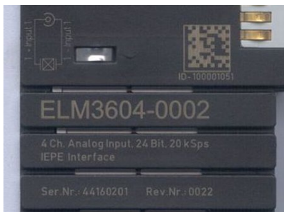
図 8: 固有のID番号 (QRコード) 100001051およびシリアル/バッチ番号44160201が記載されたELM3604-0002ターミナル
