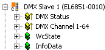
Abb. 131: TwinCAT-Baum DMX Slave, Prozessabbild bis 64 Byte Nutzdaten
