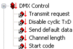
Abb. 128: TwinCAT-Baum DMX Control, Ausgangsprozessdaten
