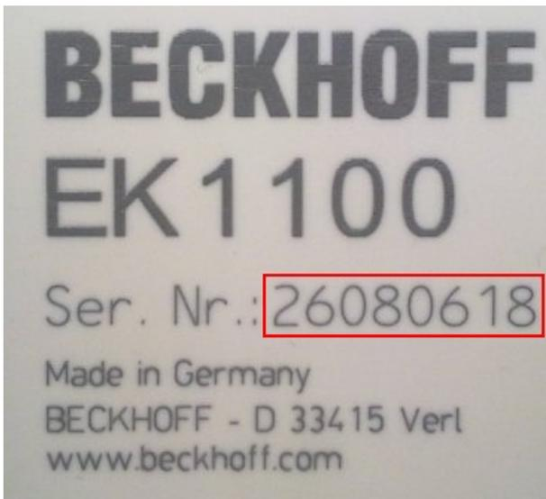
Abb. 2: EK1100 EtherCAT Koppler, Standard IP20-IO-Gerät mit Chargennummer
