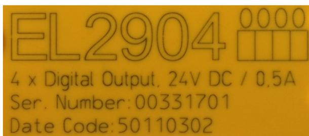
Abb. 7: EL2904 IP20 Safety Klemme mit Chargennummer/DateCode 50110302 und Seriennummer 00331701
