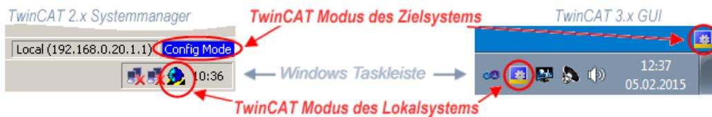
Abb. 64: Unterscheidung Lokalsystem/ Zielsystem (links: TwinCAT 2; rechts: TwinCAT 3)
