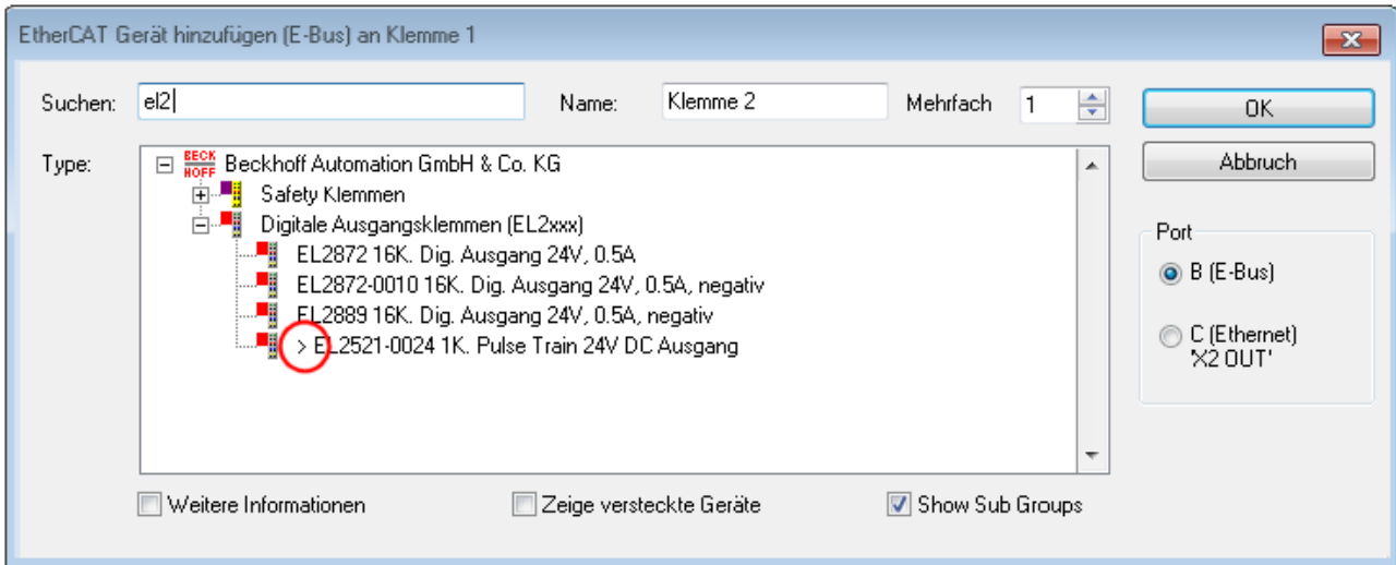
Abb. 51: Kennzeichnung einer online erfassten ESI am Beispiel EL2521
