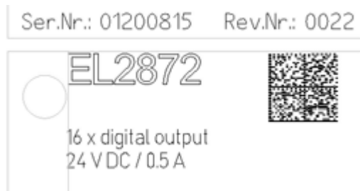
Abb. 1: EL2872 mit Revision 0022 und Seriennummer 01200815
