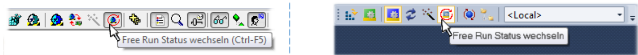
Abb. 68: TwinCAT kann auch durch einen Button in diesen Zustand versetzt werden (links: TwinCAT 2; rechts TwinCAT 3)
