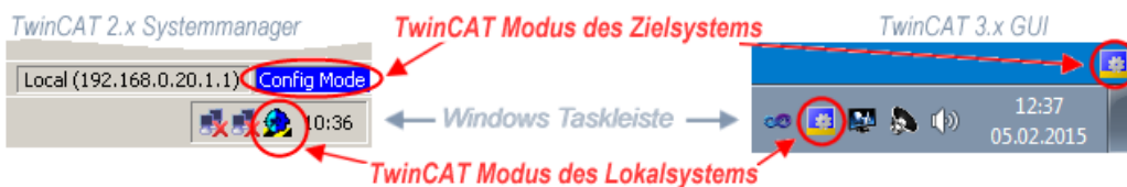
Abb. 56: Unterscheidung Lokalsystem/ Zielsystem (links: TwinCAT 2; rechts: TwinCAT 3)
