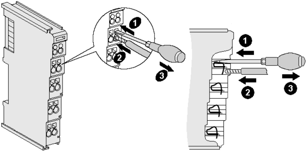
Abb. 19: Anschluss einer Leitung an eine Klemmstelle
