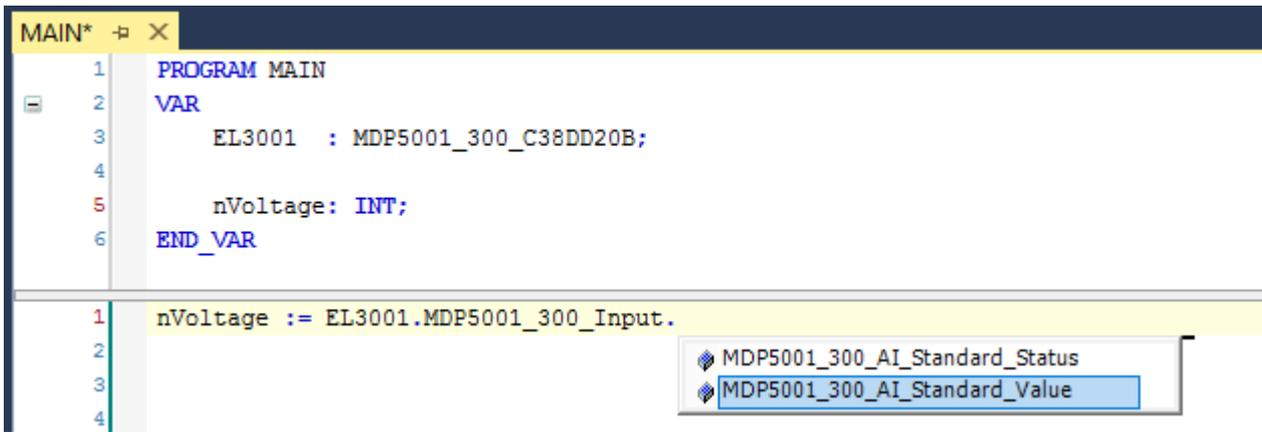
Abb. 71: Lesen einer Variable aus der Struktur der Prozessdaten
