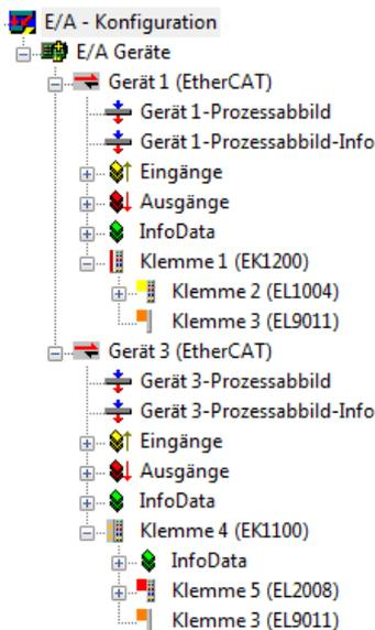
Abb. 38: Abbildung der Konfiguration im TwinCAT 2 System Manager
