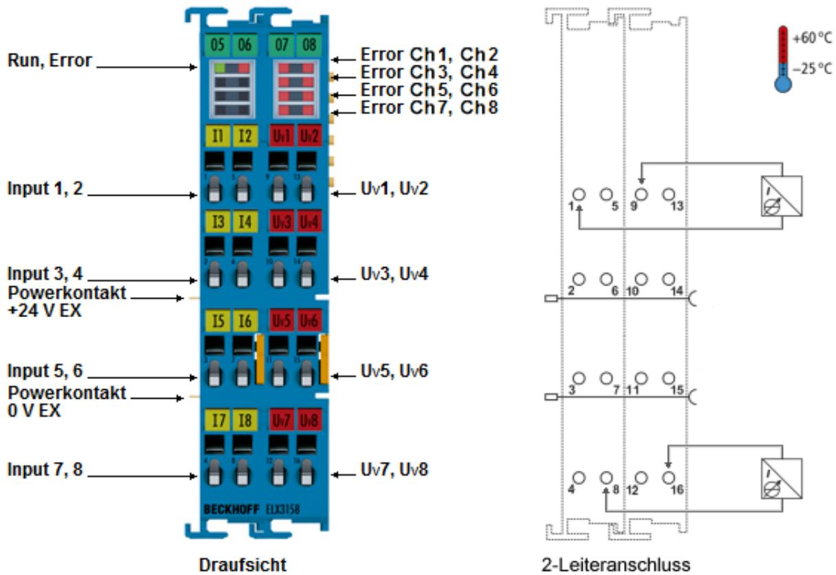
Abb. 5: ELX3158 - Achtkanalige Analog-Eingangsklemme, 4 ... 20 mA, single-ended, 16 Bit, Ex i
