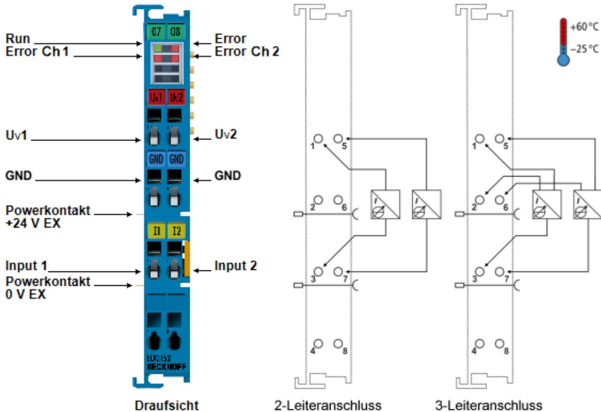
Abb. 4: ELX3152 - Zweikanalige Analog-Eingangsklemme, 0/4 ... 20 mA, single-ended, 16 Bit, Ex i
