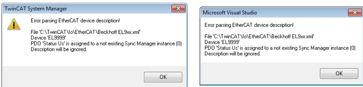
Abb. 86: Hinweisfenster fehlerhafte ESI-Datei (links: TwinCAT 2; rechts: TwinCAT 3)
