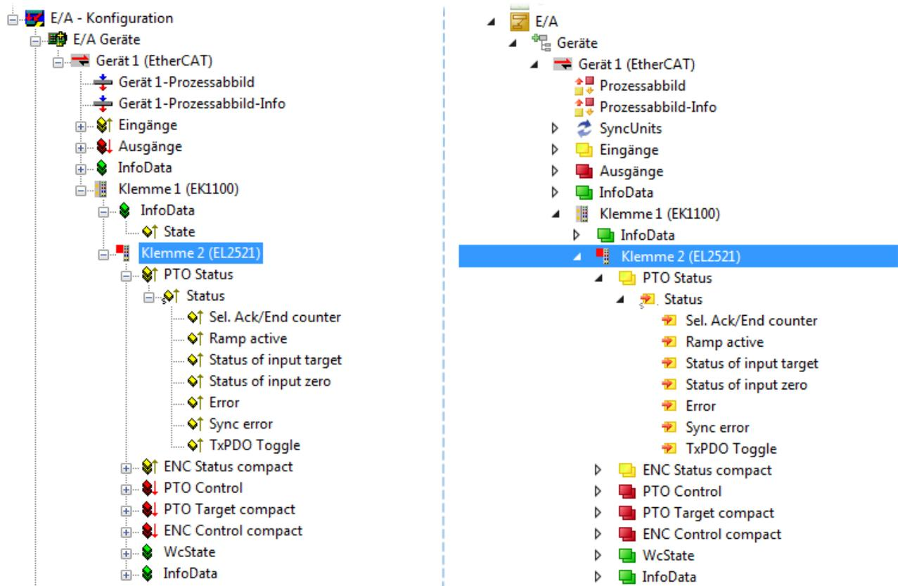
Abb. 98: EtherCAT Klemme im TwinCAT-Baum (links: TwinCAT 2; rechts: TwinCAT 3)
