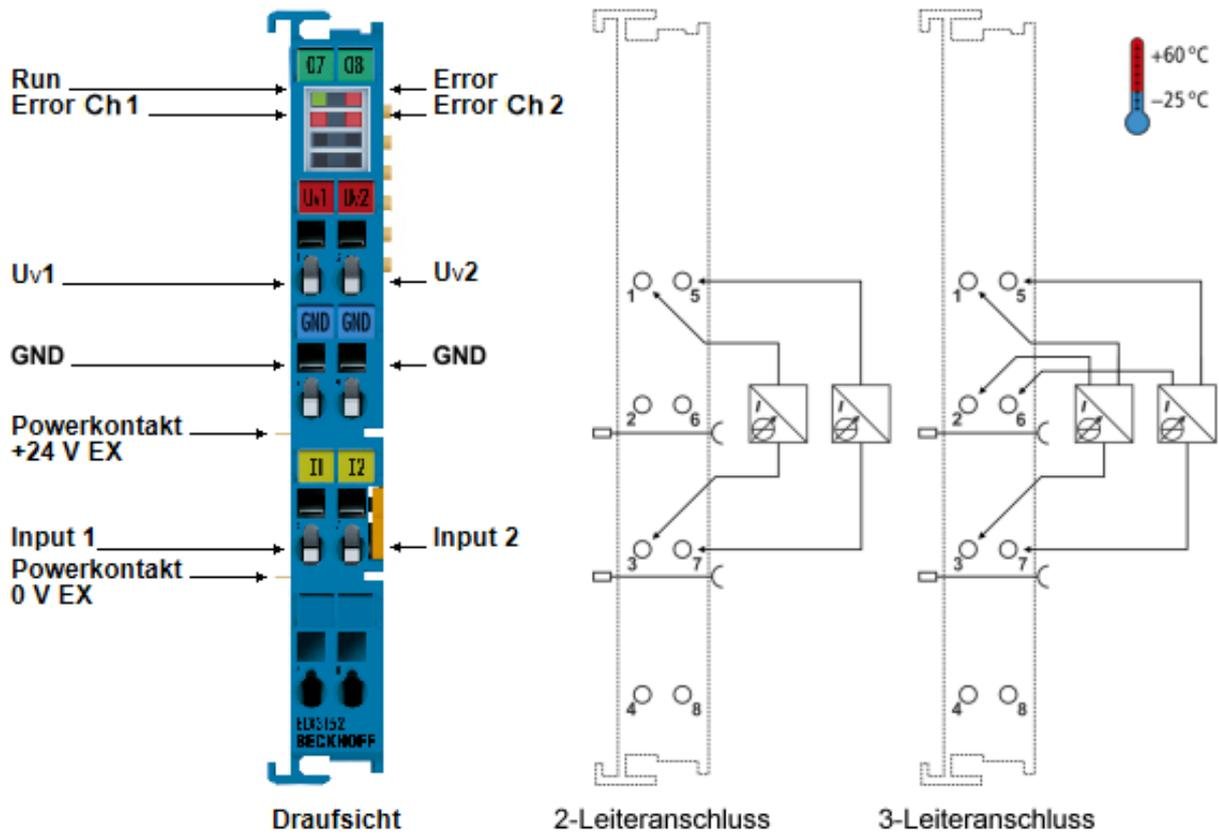
Abb. 20: ELX3152 - Anschlussbelegung
