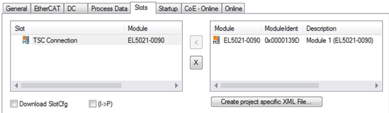
Abb. 154: Hinzufügen der TwinSAFE-SC-Prozessdaten unterhalb der Komponente z.B. EL5021-0090
