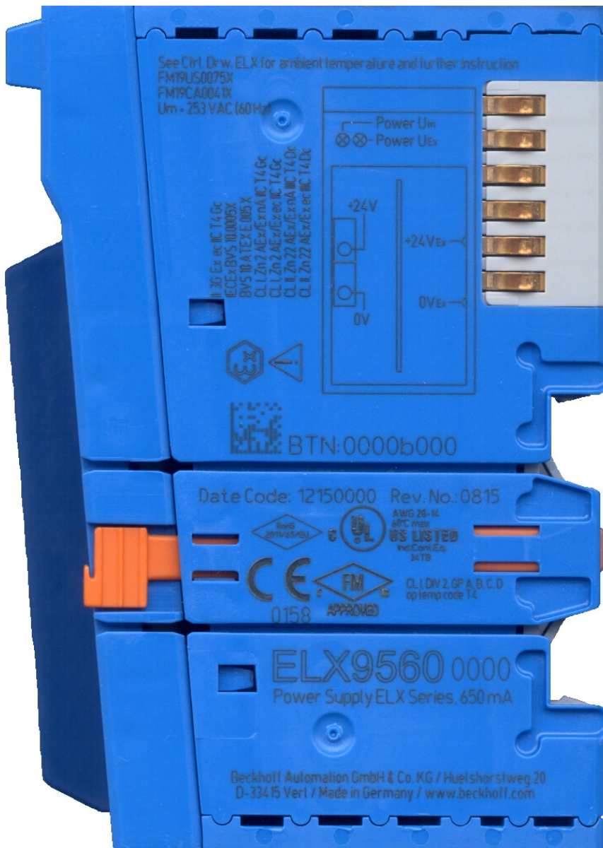
Abb. 2: ELX9560-0000 mit Date Code 12150000, BTN 0000b000 und Ex-Kennzeichnung
